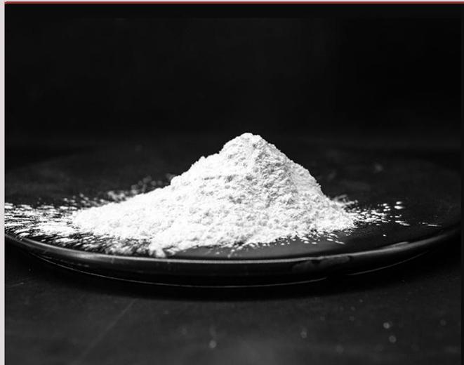
熔融氧化铝粉末是以低钠铝氧化粉为原料，经电熔提炼结晶，先用磨机制成粉末，然后经过酸洗去除杂质，利用水力进行溢流分级。其加工工艺复杂，微粉级别白刚玉的粒度分布集中，无大颗粒，适用于精细研磨，抛光。又因其化学稳定性高，硬度高，热稳定性强，耐磨性能好，也广泛应用于耐磨涂料，工业陶瓷等行业。
