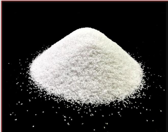
白刚玉磨料选用99含量铝氧化粉为原料，经电弧炉2400度电熔提炼结晶而成。白刚玉是工业上常用的研磨介质，它的主要晶相是 $\alpha$ -Al<sub>2</sub>O<sub>3</sub>，钠含量低于0.3%，具有耐火温度高、研磨效率高、硬度高、自锐性强的特点。海旭磨料白刚玉选用固定炉原块进行破碎、筛分，韧性和硬度比倾倒炉白刚玉高，是一种优异的研磨材料。通过对工艺流程的合理设计，控制了白刚玉砂的堆积密度、纯净度和磁性物含量。
